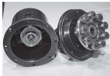
Винтовое коническое зацепление позволит изготовить эффективные ДВС, насосы и компрессоры.
