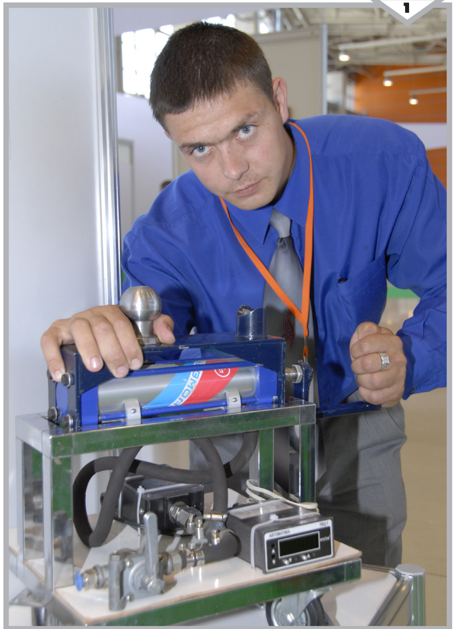
Нагрузочный проверит тормозное устройство прицепа.
