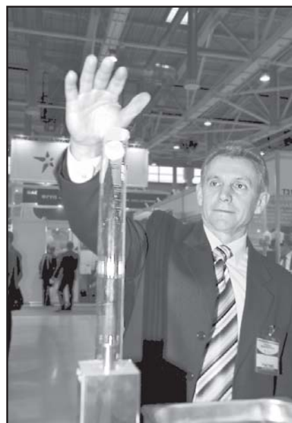
Фото 3. Воздушный столб поднимает пластиковый шарик с помощью ультразвука.
